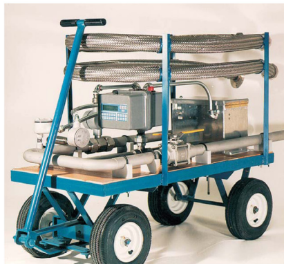
Figura 1. Sistema de medición para gas natural HOFFER utilizado en Venezuela
